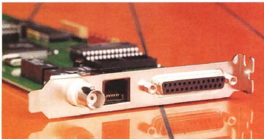
I connettori offerti dalla Ariadne sono un BNC per reti Ethernet 10BASE2 (Thin Ethernet o Cheapernet), un RJ45 per reti Ethernet 10BASE-T (Twisted Pair) e un classico Cannon a 25 poli per la prima delle due porte parallele.
